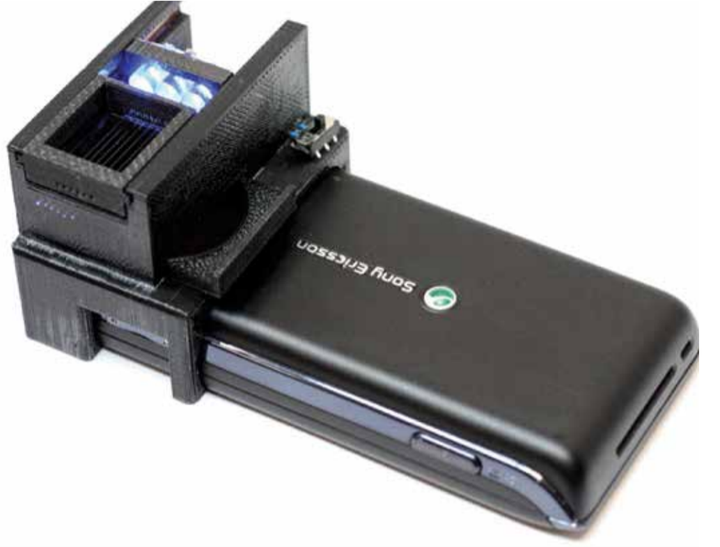
Şekil 1. Cep telefonuna adapte edilebilen Escherichia coli O157:H7 dedektörü (Analyst, 2012, 137).
