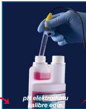
Gövdeye bastırın ve tampon çözeltinin kalibrasyon haznesine transferini sağlayın.
