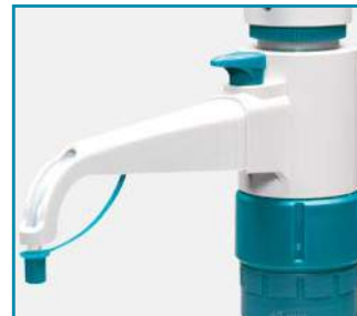
Çıkıştaki geri dönüş vanası ön işlemler sırasında sıvı kaybını önler.
