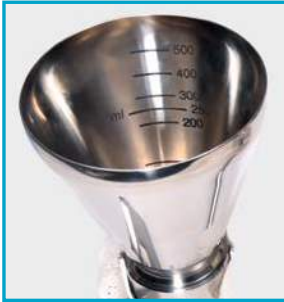
Basılı hacim çizelgesi süzülecek örneğin hacminin kolay gözlenmesine yardımcı olur.
