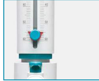
Gövde her iki yanına basılı olan hacim skalası ayarlanan hacmin kolay ve doğru okunmasını sağlar.
