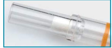
Pipet ağızındaki filtre tıkacı sıvı taşıma olasılığını önleyerek çapraz kirlenmeyi durdurur.
