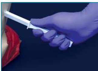
Keskin uçları plastik torba ve keseleri kolayca delerek optimum ve hızlı numune alımı sağlar.
