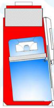
Kontamine çalışma alanını negatif basınçlı tutan plenum çevreleme ve sıfır kaçak üretim teknolojisi
